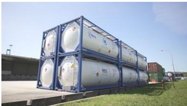
図9 MCHとトルエンを輸送するISOタンクコンテナ
