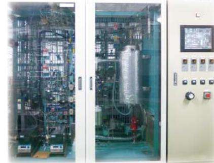
連続フロー有機合成装置(パイロットスケール)
