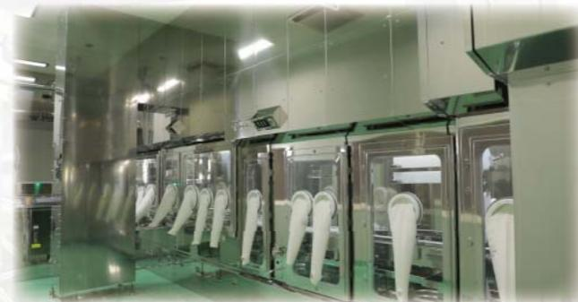
バイアル凍乾製剤 充填一連ライン
