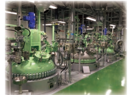
独立スイート方式を採用した原薬製造設備
