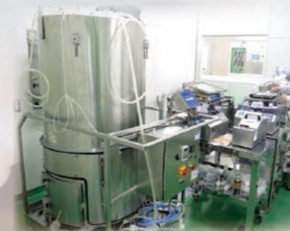
シングルユースシステムを利用した動物細胞培養設備
