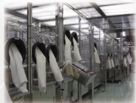
C-RABSを用いた容器自動搬送充填
