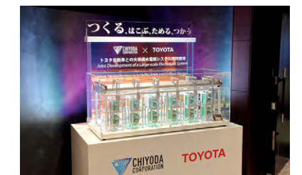
水電解装置の模型。緑色部分がトヨタ自動車(株)開発の「水電解セル・スタック」
