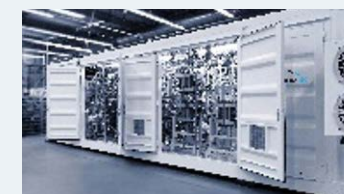
INERATEC社による工業規模のコンテナ型Power-to-Liquidプラントモジュール
