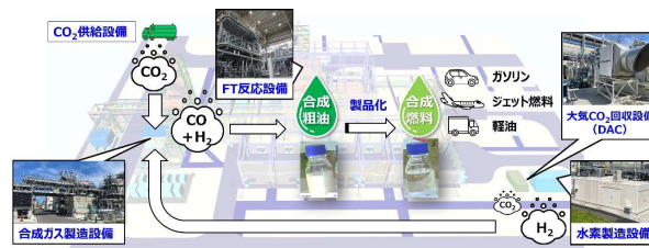
合成燃料製造実証プラント全体像 (ENEOS(株)提供)
